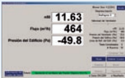
Test automático BlowerDoor con software TECTITE Express
