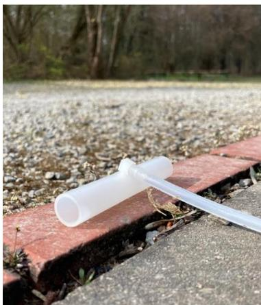
Asegúrese de que el extremo exterior del tubo no esté en el área de salida del flujo de aire del ventilador, ya que se podrían producir turbulencias. En condiciones de viento, el extremo del tubo debe colocarse lo más lejos posible del edificio o de obstáculos para medir la presión exterior en un área no afectada. Es útil colocar el tubo a sotavento en el edificio. En caso de que el tubo esté expuesto a la luz solar, colóquelo horizontalmente para evitar el flujo térmico.
