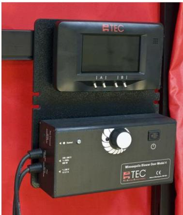
Fije el variador de velocidad y el manómetro DG-1000 a la barra transversal superior utilizando el mecanismo de fijación situado en la parte trasera de la pletina. Antes de conectar el variador al ventilador, asegúrese de que el interruptor del mismo está en posición "off" y de que el botón de regulación de velocidad está completamente girado al mínimo.
