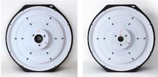
El diafragma D se une directamente al diafragma B (retire el diafragma C antes de instalar el D). La letra debe quedar hacia arriba. Cuando se utilizan los diafragmas D o E, es necesario conectar el tubo rojo de medida del caudal del ventilador (presión del ventilador) al diafragma D.
