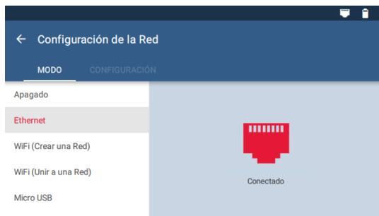
Para conectar el dispositivo mediante Ethernet, conecte el cable Ethernet al puerto Ethernet del DG-1000 y al router con conexión a internet. Ajuste el tipo de conexión seleccionado en el menú “Configuración” / “Configuración de la Red” del DG-1000.
