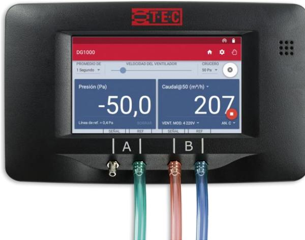
Fig. 4.28: Conexión de los tubos al DG-1000
