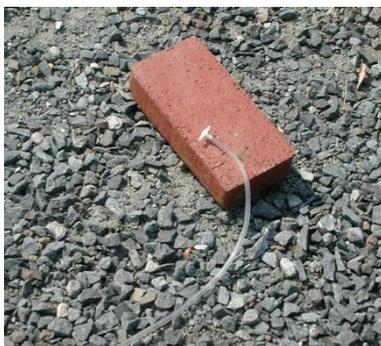
El tubo transparente de 10 m de largo se utiliza para medir la presión exterior (medición de referencia) para los gradientes de presión del edificio. Un extremo se conecta desde el exterior al conector marcado en verde del panel de nailon. El otro extremo del tubo se coloca a una **distancia de unos 10 m del edificio**, colocando en su extremo un conector de tubo T (pieza en T).
