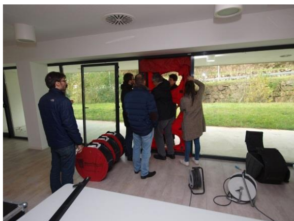
Montaje en grupo del sistema de medición BlowerDoor MultipleFan
